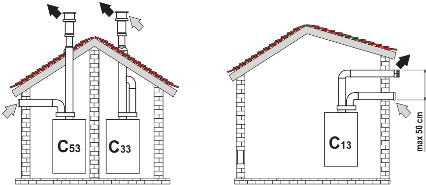
fig. 25- Ejemplos de conexión con tubos separados
